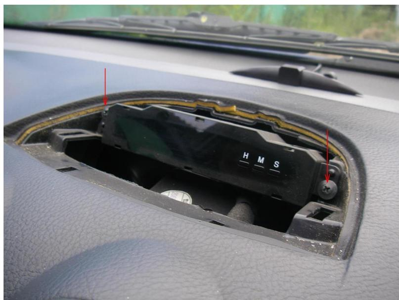
4. Отключите часы. Разберите часы на три части, **аккуратно** отжимая пластиковые защелки. Матовое стекло отложите в сторону - нам оно не пригодится. В задней части корпуса требуется проделать отверстие для подключения кабеля БК и датчиков температуры (см фото ниже). Вставьте печатную плату БК в заднюю часть корпуса часов, а затем оденьте переднюю часть, **не растеряв кнопки**, и аккуратно защелкните. Прозрачная панелька с надписью Chevrolet Lacetti устанавливается в самом конце.
