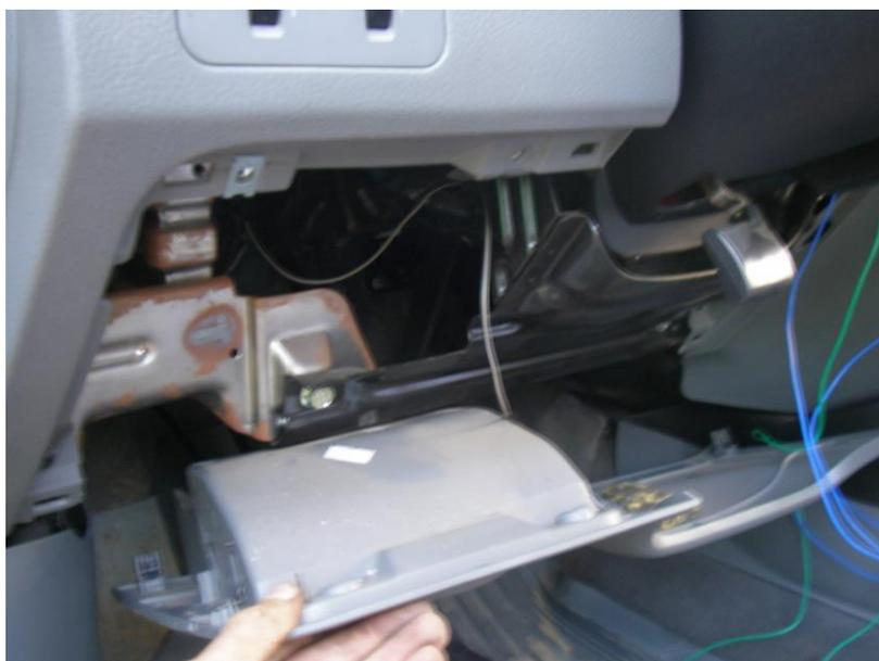
9. Убедитесь еще раз, что аккумуляторная батарея отключена. Снимаете разъем «мозгов», для чего потянуть на себя торцевую полукруглую заглушку-фиксатор (1) и потянуть жгут проводов. Затем потянув опять на себя, снимите защитный кожух разъема (2) (если он не зафиксирован стяжкой на конце, если стяжка есть, перекусить ее, а затем восстановить).
