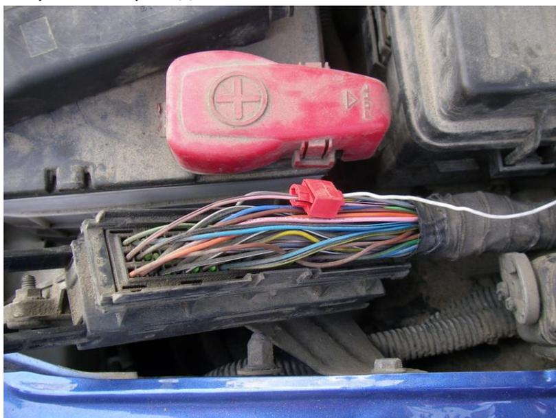
11. Одеваем кожух разъема на прежнее место, фиксируем его стяжкой. Одеваем разъем «мозгов» на прежнее место.
