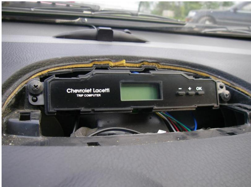
17. Подключаем аккумулятор и проверяем работоспособность бортового компьютера.
