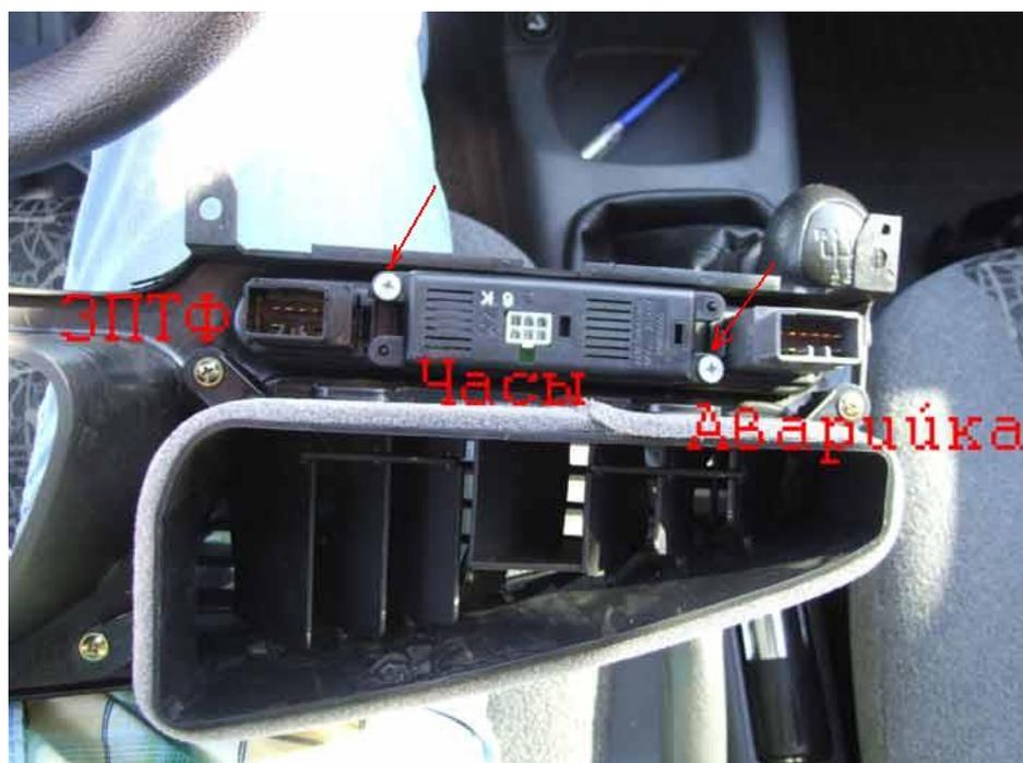
8) Откручиваем 4 шурупа, которые крепят панель приборов.
