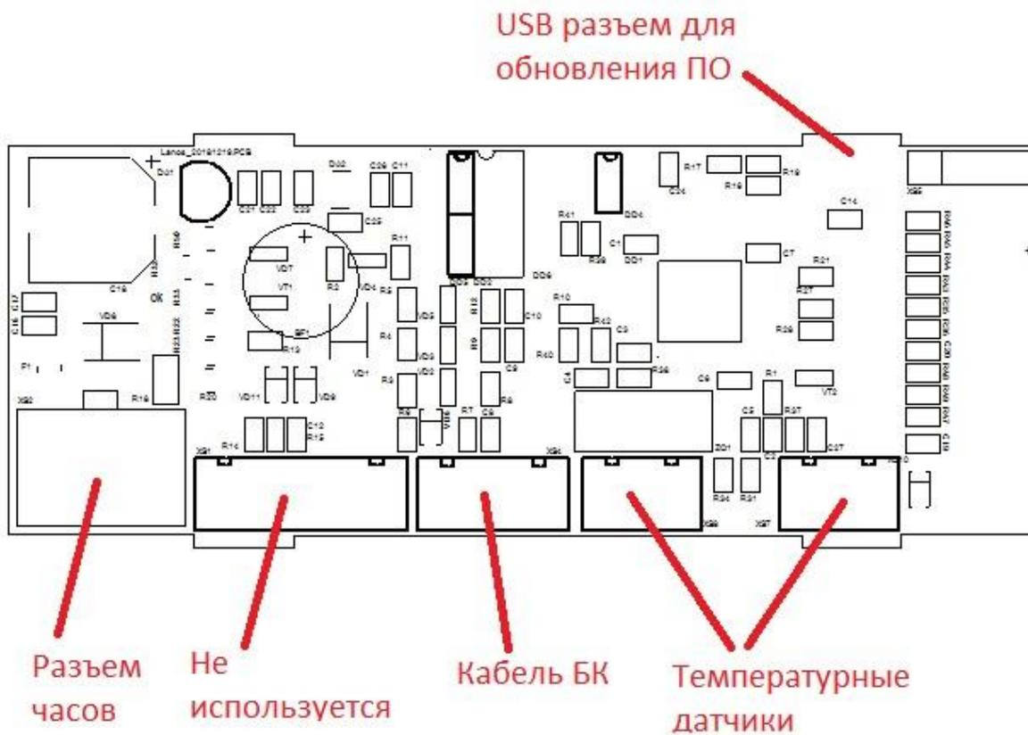
Если на автомобиль стояли часы, то нужно подключить бортовой компьютер к разъему от штатных часов (белая фишка). Если часов на машине нет и нет белого разъема от часов, требуется изготовить кабель для подключения питания, используя картинку ниже.
