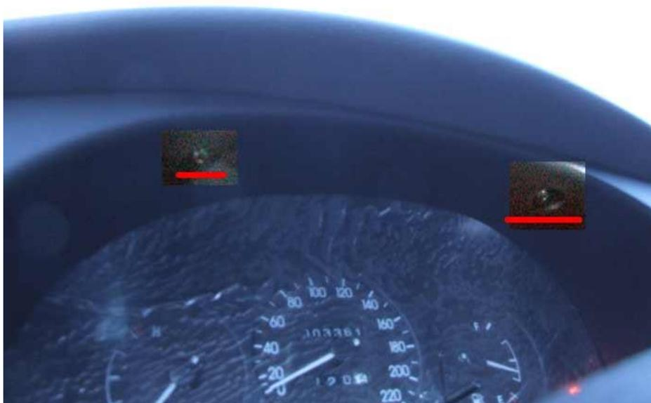
7) После этих манипуляций можно снять декоративную панель. Немного тянем ее на себя, на сколько позволят провода часов. Отсоединяем фишки от часов, кнопки аварийной сигнализации и кнопки включения ЗПТФ. После чего аккуратно вынимаем панель. Она больше ни за что не крепится.
