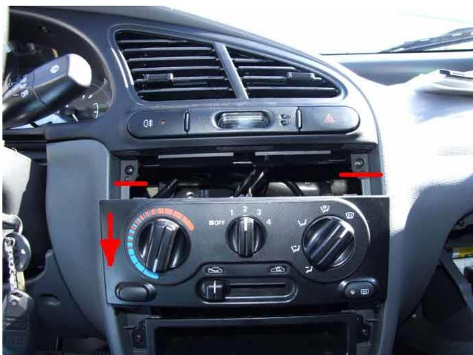
6) Откручиваем 2 шурупа, расположенных сразу над панелью приборов.
