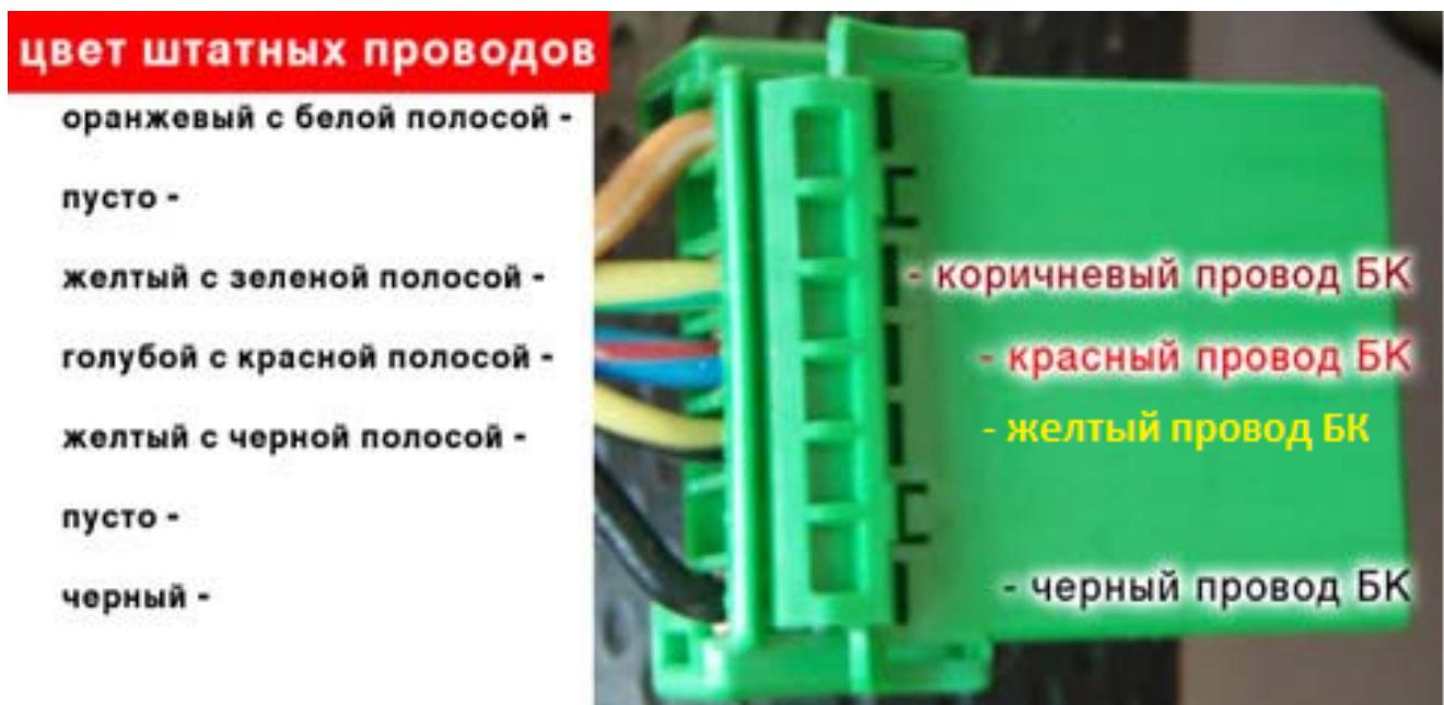
7. Пробросить ЗЕЛЕНЫЙ СИНИЙ провода БК к Приборному Щитку
